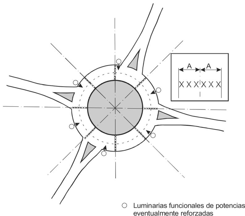
El número de puntos de cálculo de cada uno de los 8 radios es función del número de carriles de tráfico del anillo de la glorieta, a razón de 3 puntos por carril de anchura (A), tal y como se representa en la figura 7.
